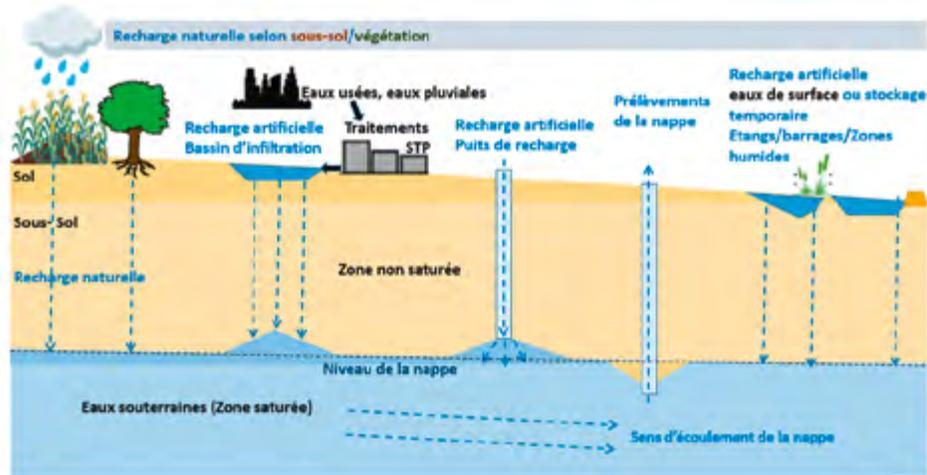
**Figure D2 – Exemples de dispositifs de recharge indirecte des aquifères à partir de bassin d'infiltration aménagés ou dépressions naturelles, zones humides alimentées par différentes sources d'eau (eaux usées traitées, eaux de pluie, eaux de surface) et recharge directe par puits.**
