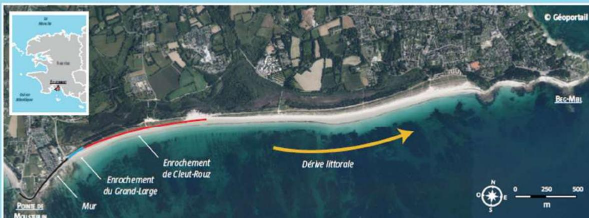
Figure 25 : positions des ouvrages littoraux et sens de la dérive littorale dominante entre les sites de Mousterlin et Beg-Meil à Fouesnant.
