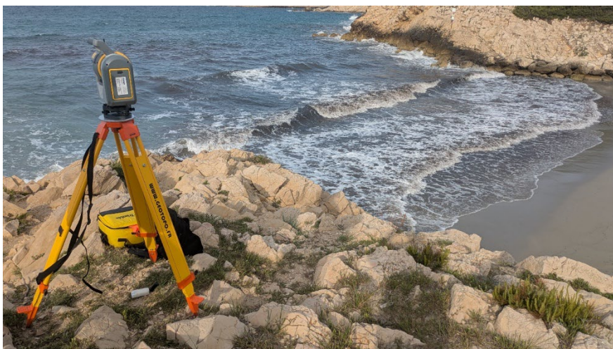
Figure 12 : Déploiement du Scan laser du Cerema sur les plages de l'anse de Sainte Croix en mai 2025 (Source : Céline Trmal, Cerema)
