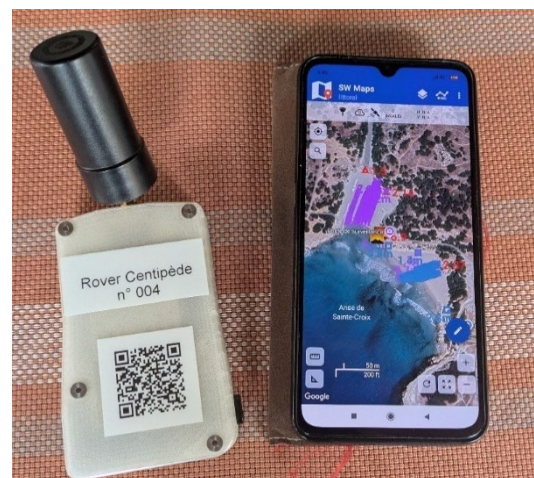
Figure 10 : Dispositif Rover RTK (Source : Céline Trmal, Cerema)
